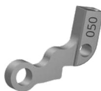
Les trois derniers chiffres de la référence sont inscrits sur le cliquet de verrouillage. Plus ce nombre est élevé, plus le cliquet de verrouillage est long. Attention pour les commandes ultérieures : si du jeu apparaît à l'usage, prenez la longueur supérieure suivante de cliquet de verrouillage.
